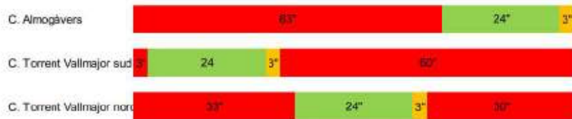
Imatge 5. Cicle i fases semafòriques dels semàfors per a vehicles de la cruïlla del carrer dels Almogàvers i el carrer del Torrent de Vallmajor. Font: Elaboració pròpia.
