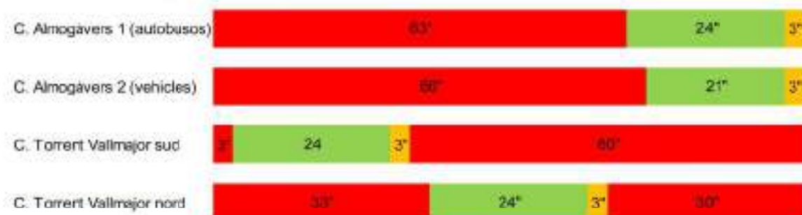
Imatge 14. Cicle i fases semafòriques dels semàfors per a vehicles de la cruïlla del carrer dels Almogàvers i el carrer del Torrent de Vallmajor, tenint en compte el doble semàfor en el carrer dels Almogàvers.
