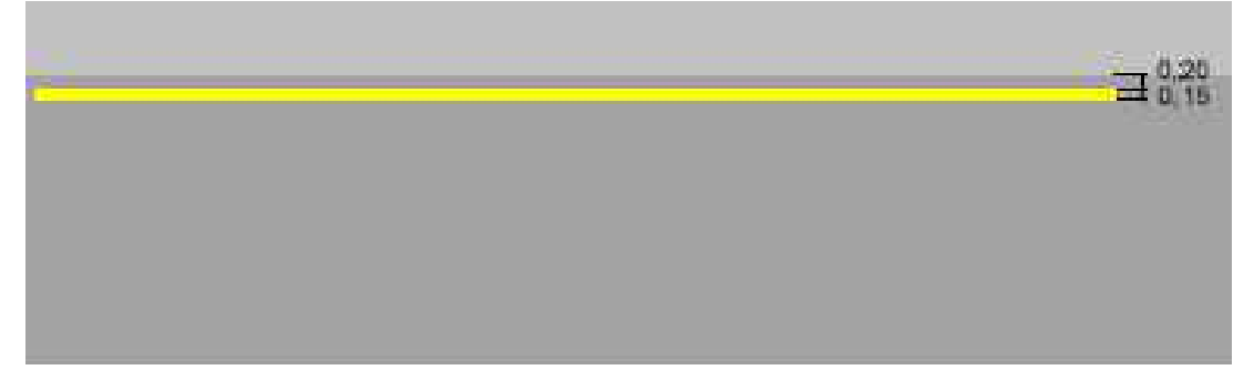
E-12 LÍNIA DE PROHIBICIÓ DE PARADA
