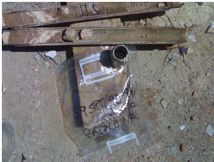
Muestra SPT extraída del sondeo S.9 entre 9.0 – 9.6 m de profundidad.
