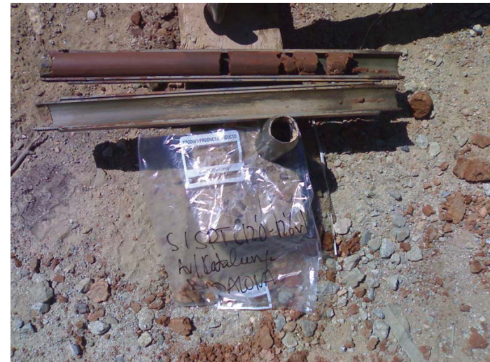
Muestra SPT extraída del sondeo S.4 entre 12.0 – 12.6 m de profundidad.
