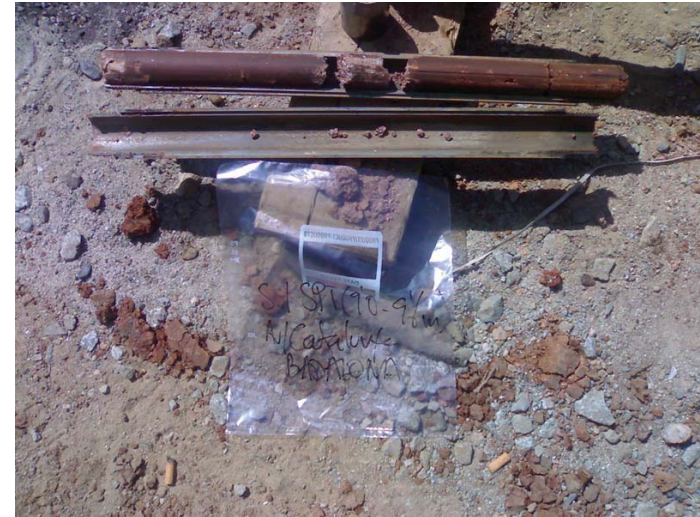
Muestra SPT extraída del sondeo S.4 entre 9.0 – 9.6 m de profundidad.
