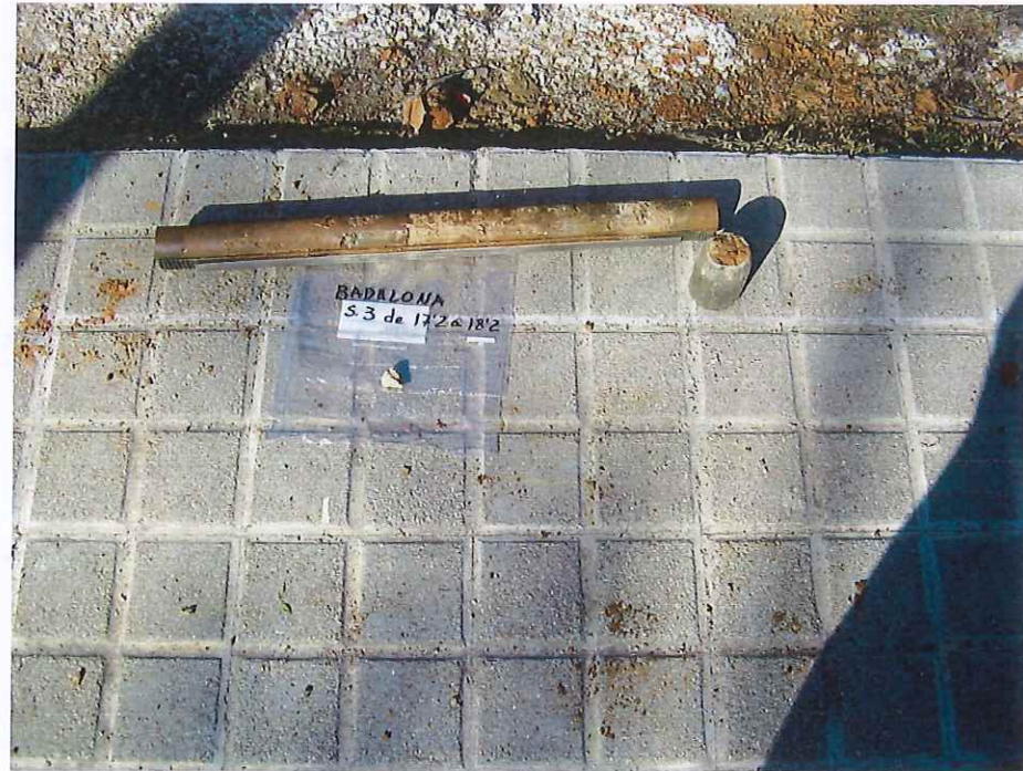
Sondeo S.3 SPT de 17.2 a 17.8 m. de profundidad
