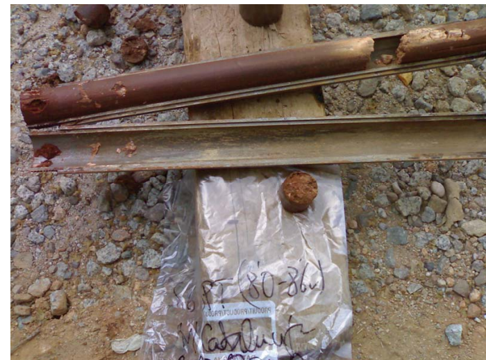
Muestra SPT extraída del sondeo S.4 entre 8.0 – 8.6 m de profundidad.
