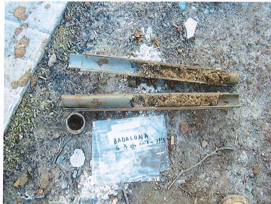
Sondeo S.3 SPT de 20.7 a 21.3 m. de profundidad
