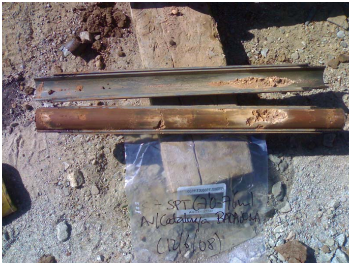
Muestra SPT extraída del sondeo S.4 entre 7.0 – 7.6 m de profundidad.
