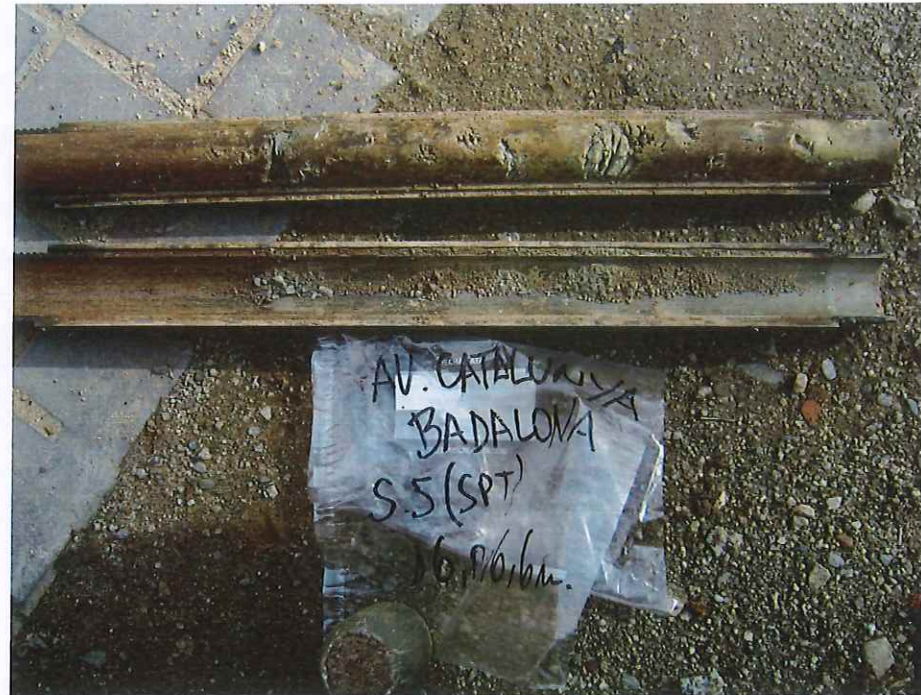
Sondeo S.5 SPT de 16.0 a 16.6 m. de profundidad
