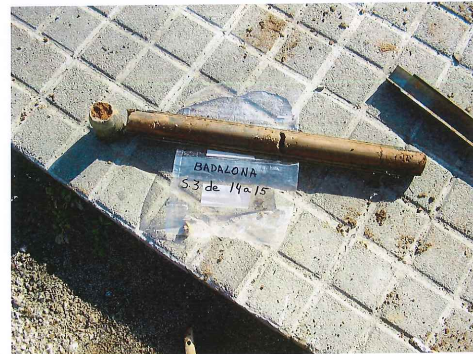
Sondeo S.3 SPT de 14.0 a 14.6 m. de profundidad
