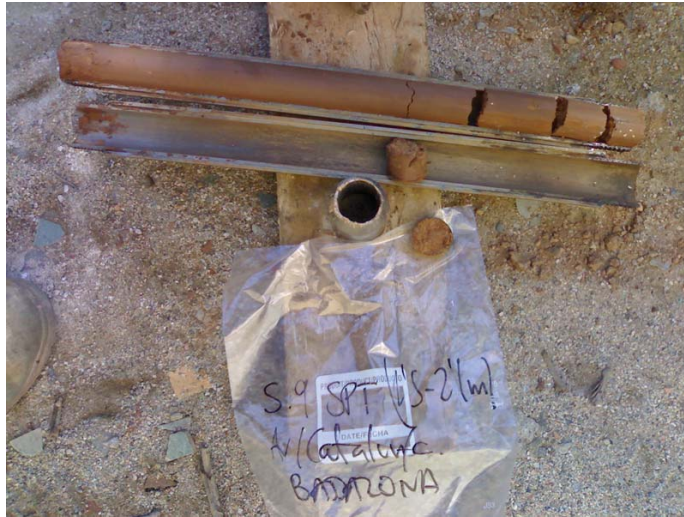
Muestra SPT extraída del sondeo S.7 entre 1.5 – 2.1 m de profundidad.
