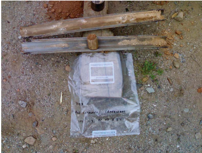
Muestra SPT extraída del sondeo S.2 entre 1.5 – 2.1 m de profundidad.
