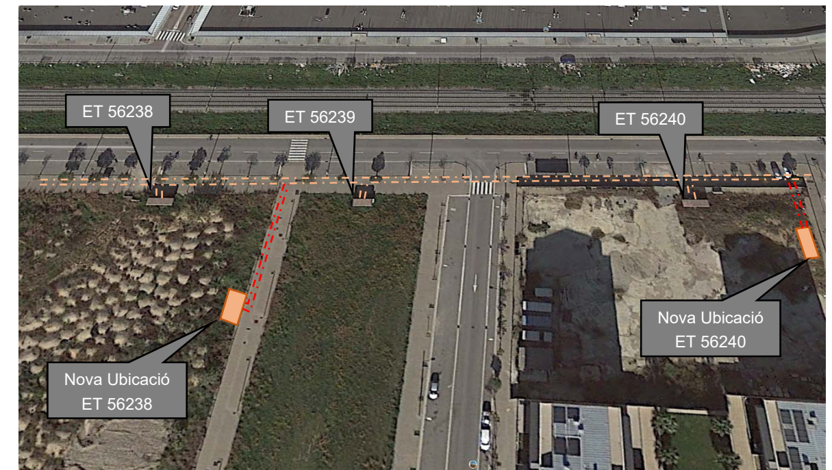
Foto 2. Esquema noves conduccions per alimentació de les ET's 56238 i 56240
